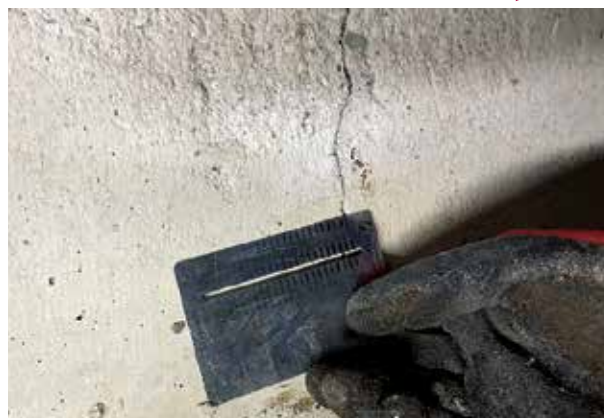
⑧基礎のクラック幅計測
